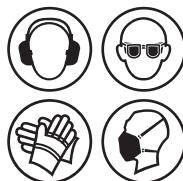
Durante l'uso del dispositivo, è necessario indossare Dispositivi di Protezione Individuale (DPI), quali protezioni auricolari, protezione per gli occhi, guanti di sicurezza e una maschera antipolvere.
