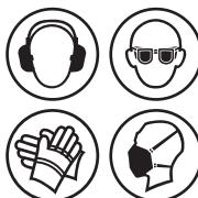
Persönliche Schutzausrüstung (PSA) wie Gehörschutz, Augenschutz, Schutzhandschuhe und eine Staubmaske müssen während des Betriebs des Gerätes getragen werden.
