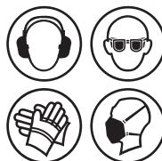
Les équipements de protection individuelle (EPI), par exemple protections auditives, protection oculaire, gants de sécurité et masque à poussière, doivent être portés pendant l'utilisation de l'appareil.
